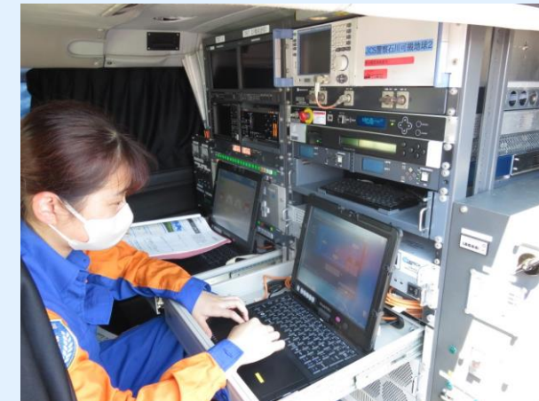
応急通信対策車の衛星設備での映像伝送訓練
